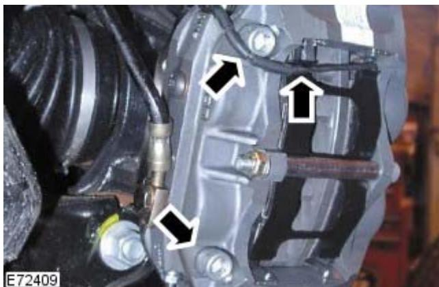
1. 拆卸制动盘的程序与 Range Rover 《车间维修手册》中所述基本相同，不同之处是制动盘通过凹头螺钉来固定。
